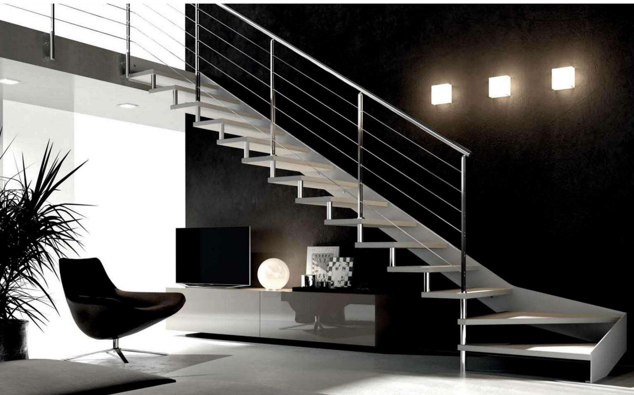
Configurazione singolo cosciale in metallo lineare , pedata in legno, ringhiera autoportante con fissaggio interno mod. R5 in acciaio
